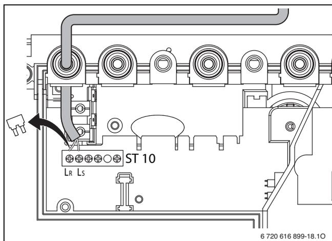
Fig. 43 Raccordement du TRV .. (230 VCA, retirer le cavalier entre L<sub>S</sub> et L<sub>R</sub>)
